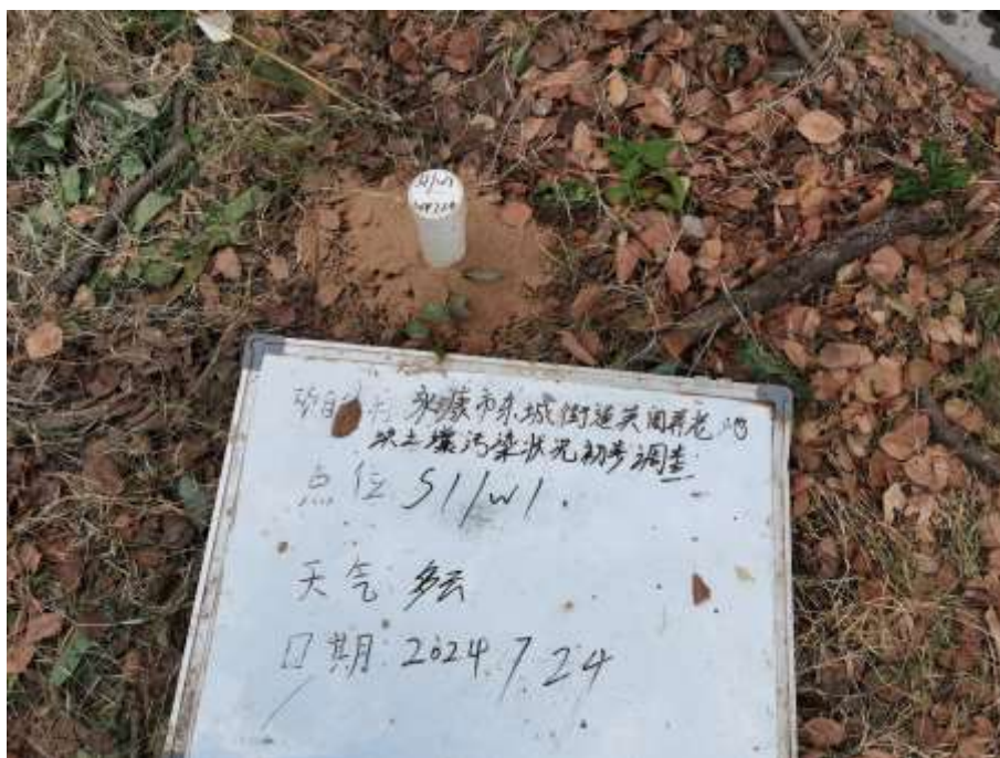
图 5.1-2 现场成井照片
