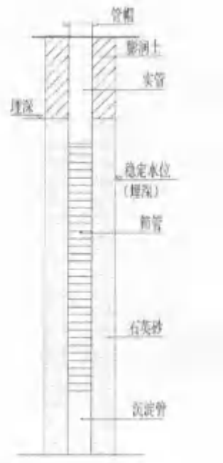
图 5-1 地下水采样建井示意图
