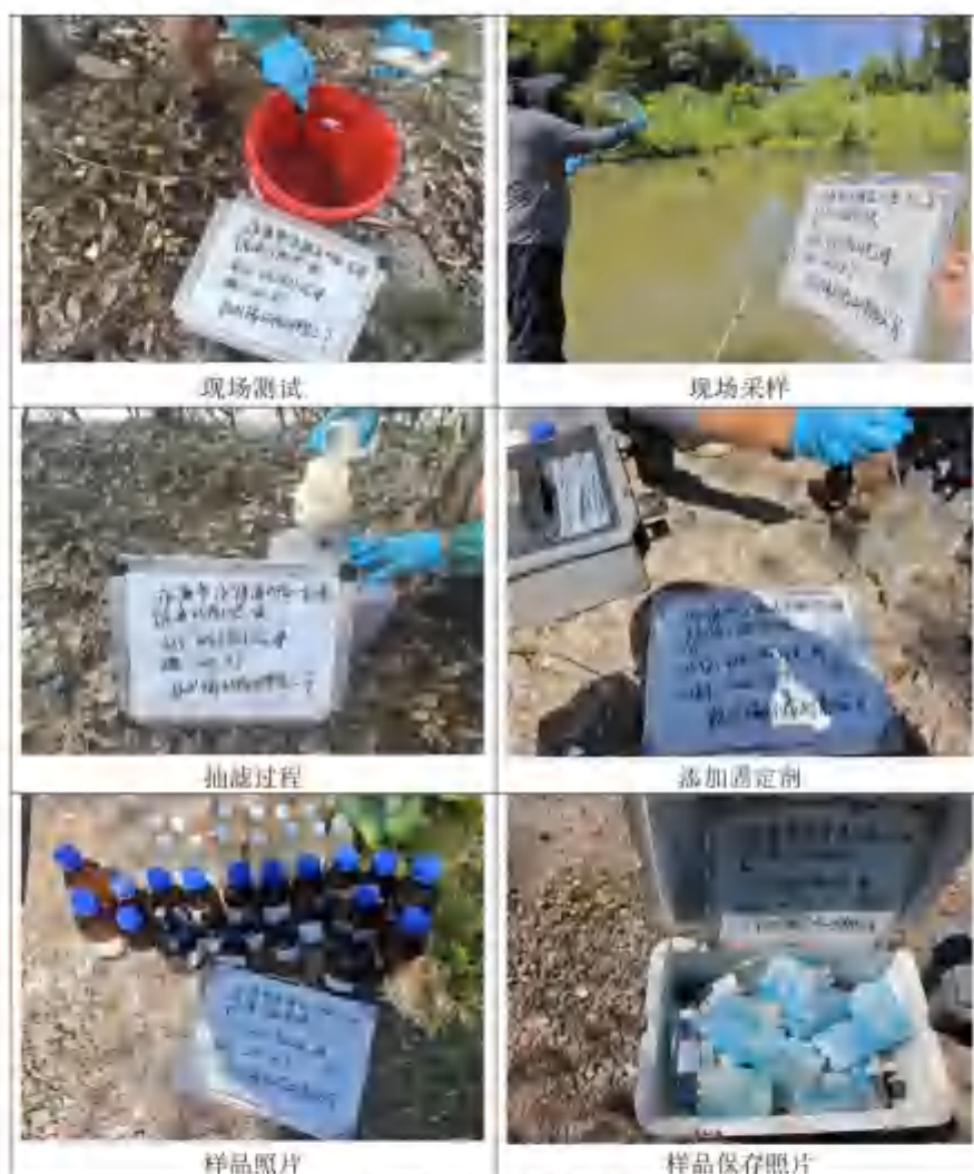
图 6 地表水样品采集过程
