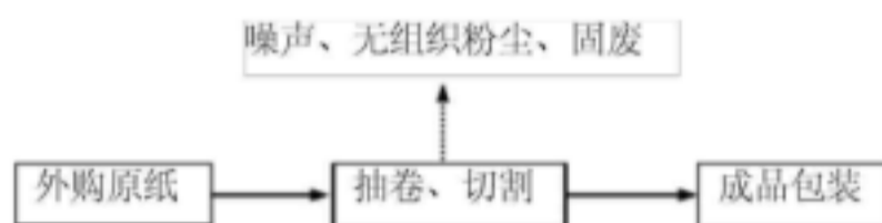
图 3-39 生产工艺流程图
