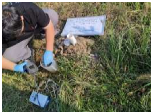
采样前洗井检测
