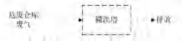
图 3-62 危废仓库废气处理工艺流程图
