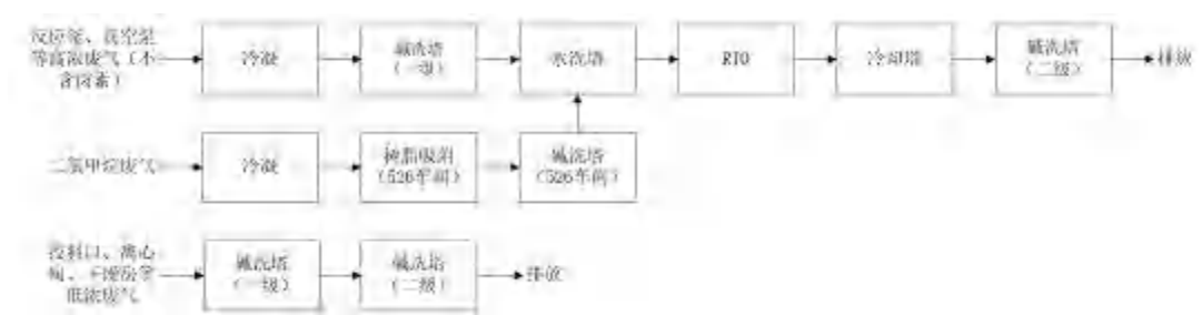
图 3-59 525 车间废气处理工艺流程图
