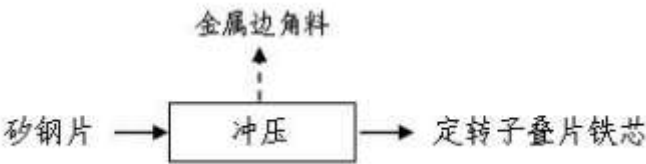
图 3-22 定转子叠片铁芯生产工艺流程图
