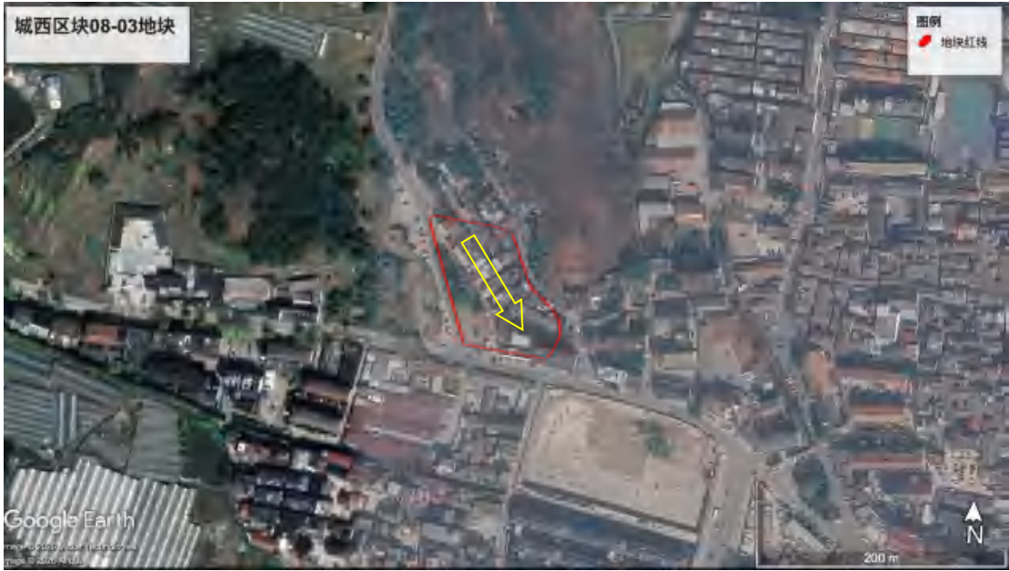
图 3-8 地块地下水流向
