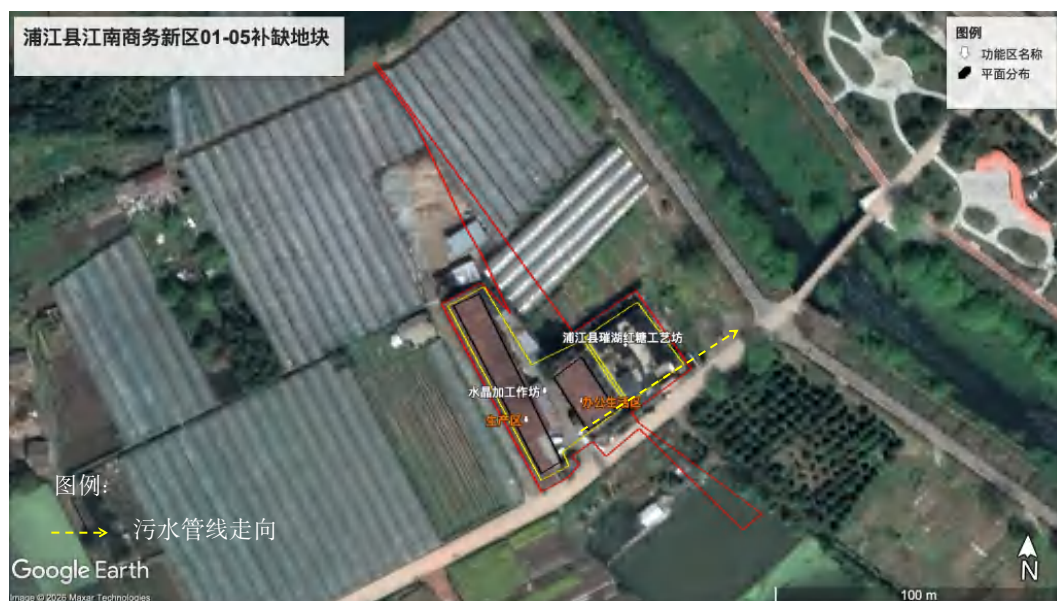
图 3-20 污水管网走向图
