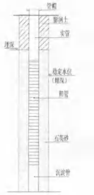
图 5-1 地下水采样建井示意图
