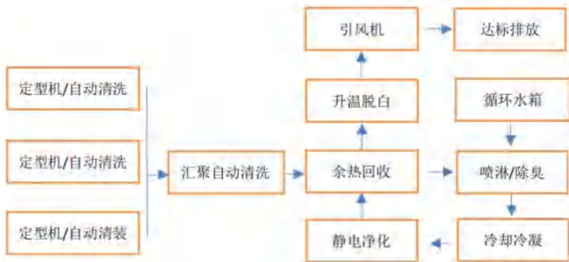
图 4.1.2-2 定型废气治理工艺流程图 (DA010)
