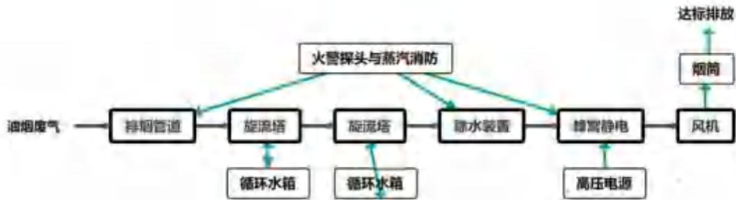
图 4.1.2-6 定型废气治理工艺流程图 (DA024)
