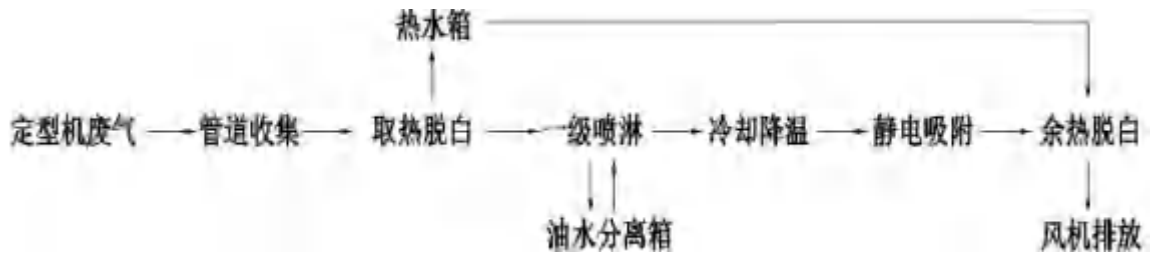
图 4.1.2-5 定型废气治理工艺流程图 (DA018)
